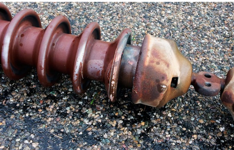
Defekter Isolator nach Blitzeinschlag.
